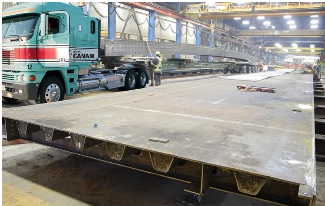
Esempio di lastra a comportamento ortotropo
