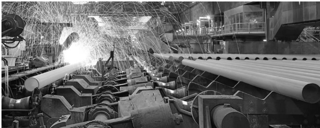
Produzione di tubi senza saldatura – Foto: Tenaris Dalmine
