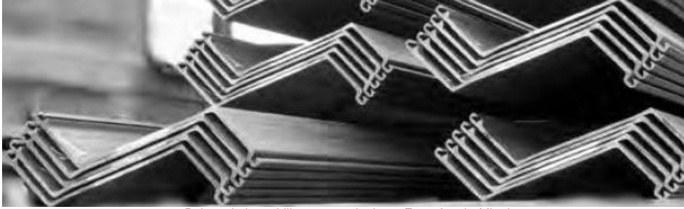
Palancole in stabilimento produttivo – Foto: ArcelorMittal
