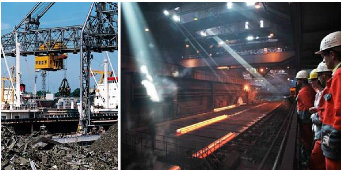
Riciclo di rottame ferroso e produzione di profili in acciaio © ArcelorMittal
