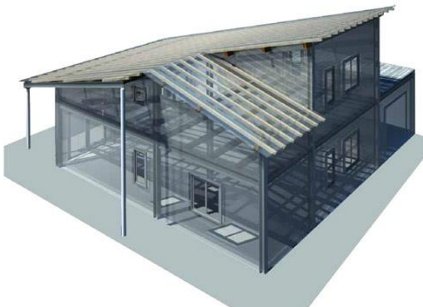
Schema Struttura/Rivestimento della Whisehouse01 © Edilizia Integrale spa
