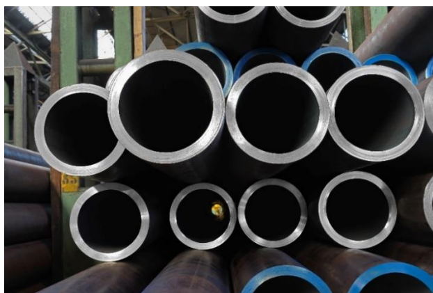
Fig.5 – Prodotti tubolari in magazzino UNI EN 10210-1
