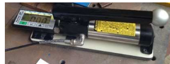
Fig. 3. Strumento e modalità di prova (UNI EN ISO 4624).
