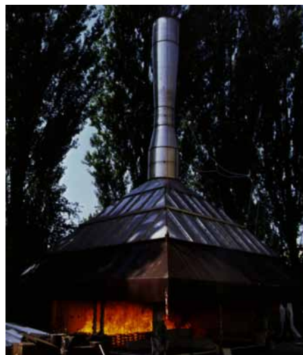
Figura 5 - Configurazione del test al "calorimetric hood" e l'esecuzione di una prova (tratto da [13]).
