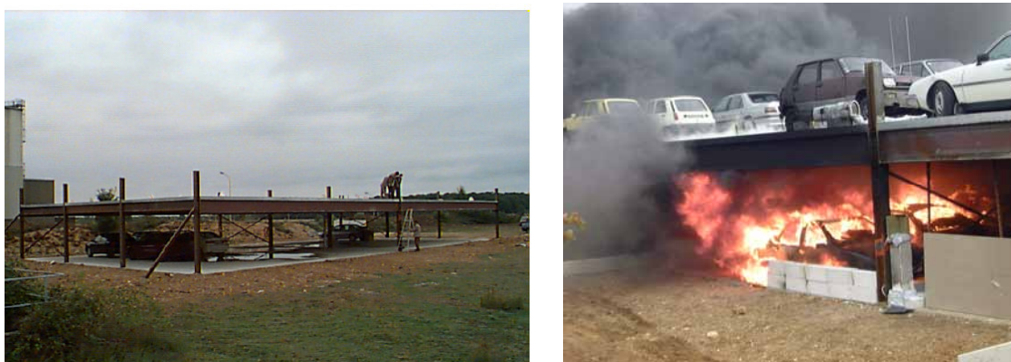
Figura 8 - Foto del prototipo durante la costruzione e durante una prova sperimentale di incendio.
